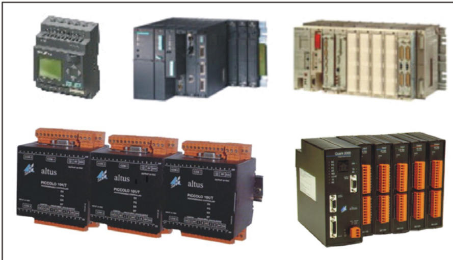
Fig. 2 – Exemplos de CLPs (Siemens e Altus – Dois grandes fabricantes de CLPs).
